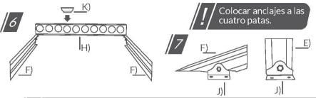
Colocar el tanque sobre la estructua y orientarlo hacia el sur geográfico en el lugar donde quedará definitivamente. Antes de continuar con la colocación de tubos, es necesario realizar las conexciones de agua fría del tinaco al calentador solar, y de la salida de agua caliente del calentador solar a la red de agua caliente de la vivienda.
